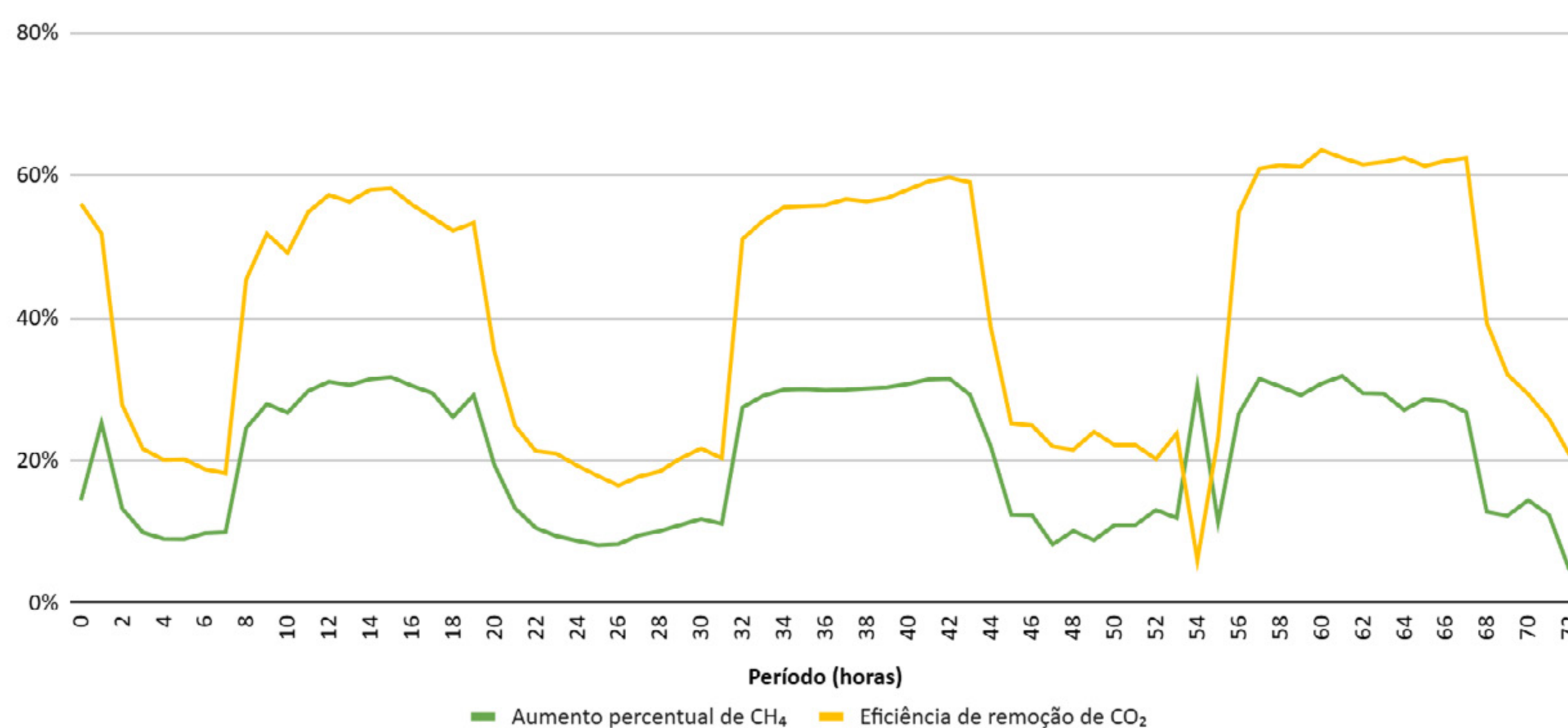
Figura 4. Eficiência de remoção de CO 2 e percentual de aumento de CH 4
