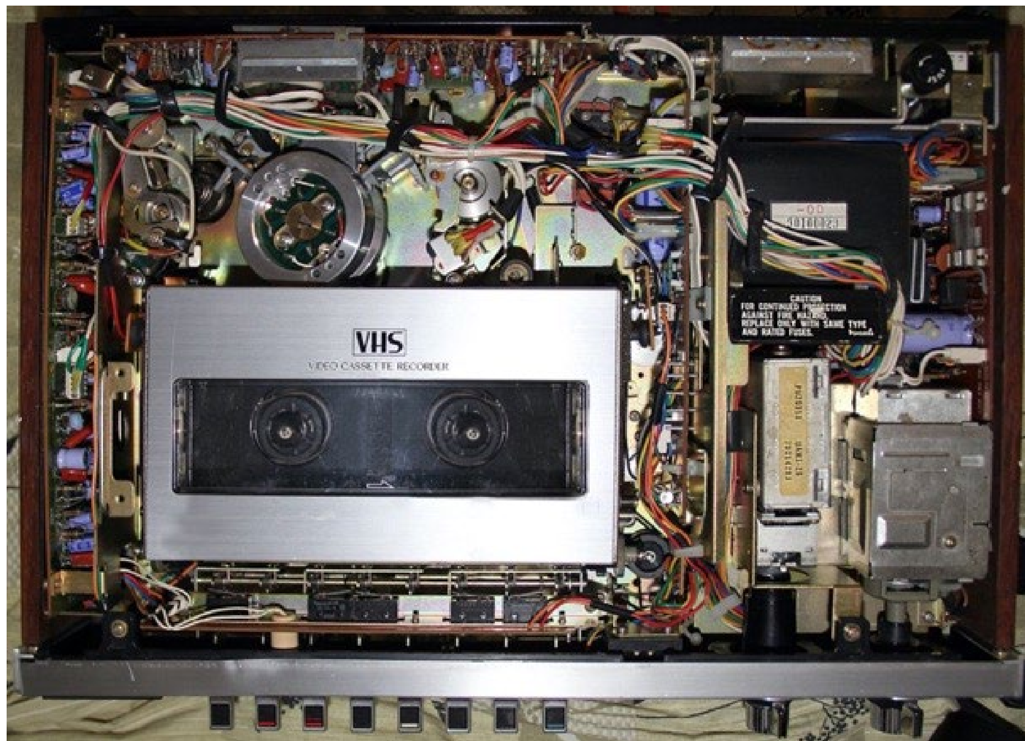
Figura 2 – Por dentro do modelo JVC HR-3300, primeiro videocassete lançado pela JVC com formato VHS.
